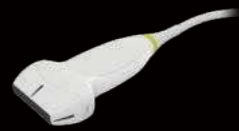
5 - 12 MHz Linear Array
